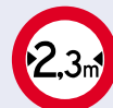
C18 Gesloten voor voertuigen die, met inbegrip van de lading, breder zijn dan op het bord is aangegeven
